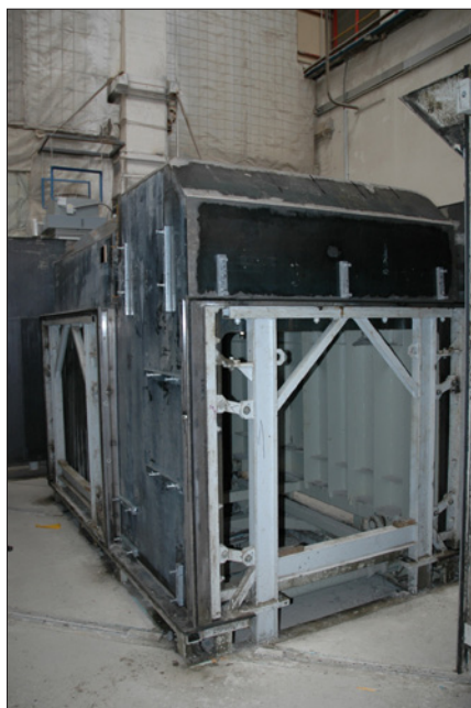
Obr. 6. Forma pro výrobu korpusu kompaktní stanice UKL 3119
