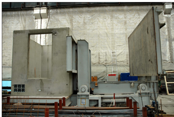
Obr. 9. Korpus je na převraceči obrácen do přirozené polohy
