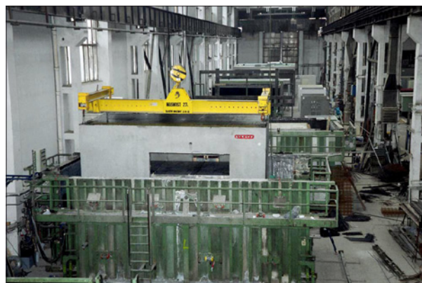
Obr. 8. Vytažení korpusu z formy – dnem vzhůru
