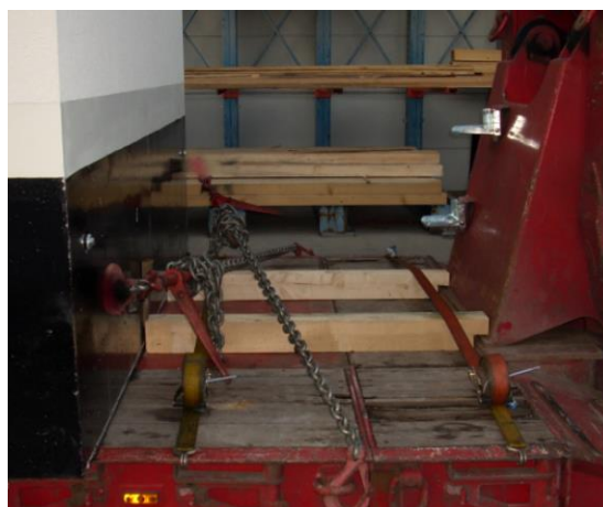
Obr. 16: Blokování pomocí klanic nebo hranolů
