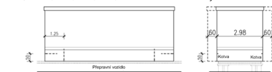
Obr. 15: Použití kotev pro zajištění nákladu v případě pochozích stanic řady UF
