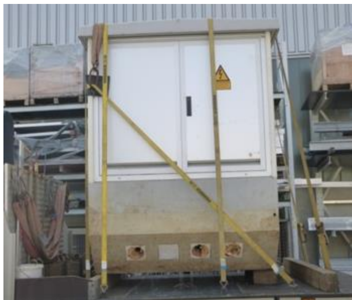
Obr. 12: Třecí přivazování (vlevo) a protahování vázacích prostředků (vpravo)
