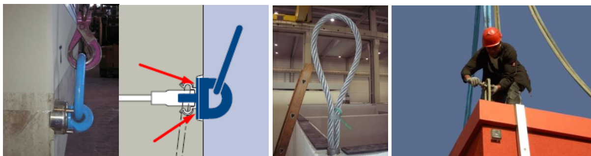
Obr. 21: Příklady správně zašroubovaných vázacích prostředků
