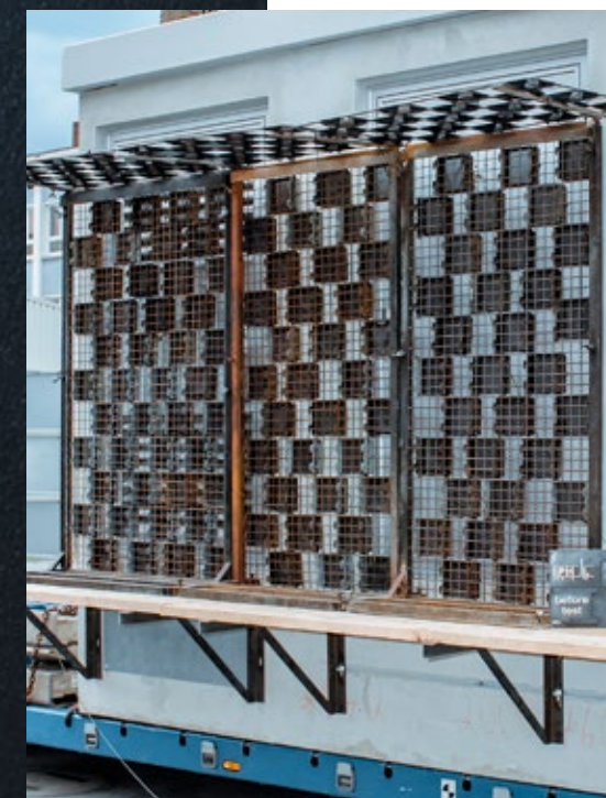
Störlichtbogenprüfung nach IAC-B für Passantenschutz 20 kA 1s
