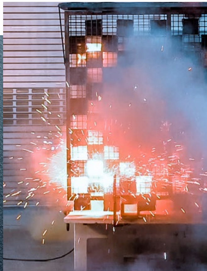
Störlichtbogenprüfung nach IAC-A für Bediener 20 kA 1s
